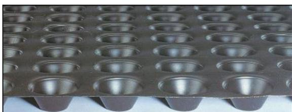
**DRAIN<sup>AIR</sup>-sape** forme avec sa surface d'appui une lame d'air libre de 14 litres/m<sup>2</sup>. Les nopés ont une hauteur de 2cm et une surface d'appui de 14%. Les nopés coniques (289 pièces/m<sup>2</sup>), remplies de mortier ou de béton (5 litres/m<sup>2</sup>), constituent des piliers solides qui forment la lame d'air. La capacité portante de l'ensemble est dépendante de la résistance du matériau de remplissage et de la portance de la construction.
